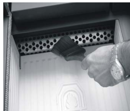
Fig. 4 – Nettoyage du déflecteur XENIA
